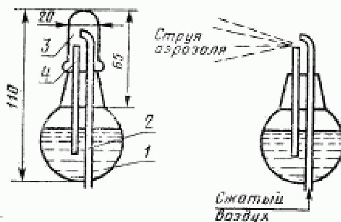
1—колба; 2—воздушная капиллярная трубка; 3—крышка со шпанфом; 4—распределительная трубка
