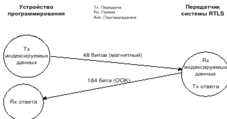
Рисунок 13 — Обмен сообщениями между устройством программирования и передатчиком системы RTLS для передачи команд считывания
