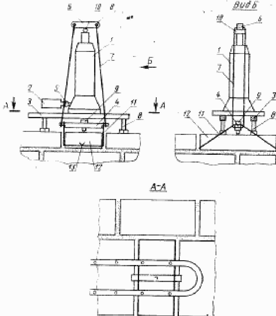
1—гидравлический домкрат; 2—манометр; 3—рама; 4—перекладина; 5—переходник; 6—траверса; 7—тяги; 8—стойки рамы; 9—регулируемый болт; 10—шарнир; 11—тросовый захват; 12—цепный кирпич (камень); 13—узел троса.
