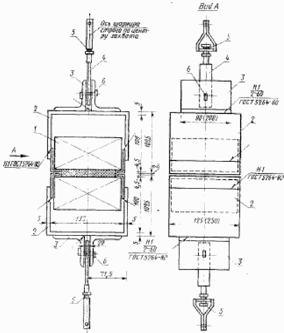
1—образцы; 2—металлический захват; 3—уголки 60 × 60 × 6 мм; 4—металлическая пластина 20 × 90 × 6 мм; 5—шарик; 6—шпилька.
