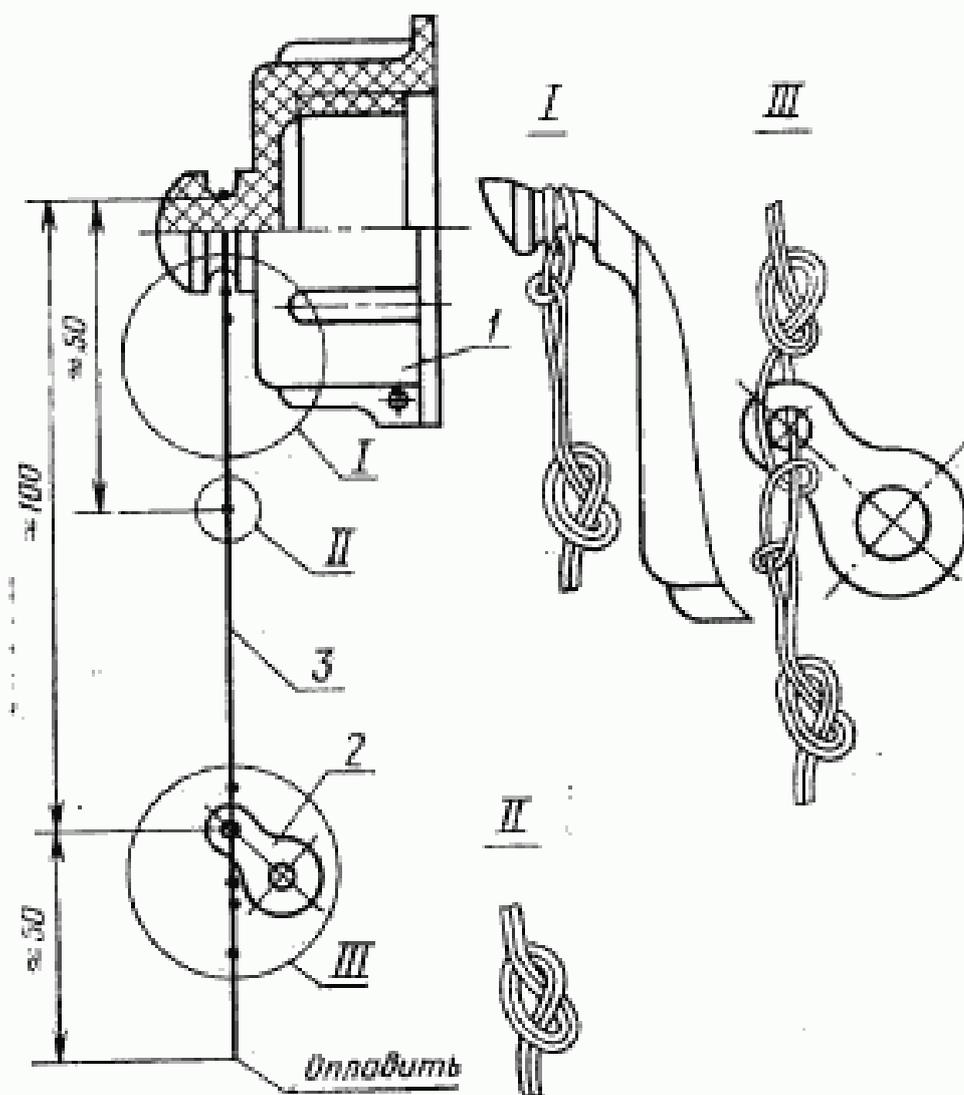
1 — крышка 1-M24×1—3Ф; 2 — ушко 3,4; 3 — капроновая нить 3К или леска 0,8 мм  $l=300 / \text{м}$  17 ( $\pm 2,6$ ) мм.
