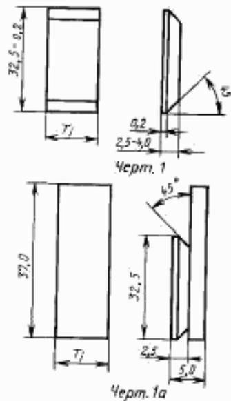
Номинальный размер ширины планки равен ширине площадки  $T_1$ . Предельные отклонения, мм, на ширину планки:  $T_1$  мм:
