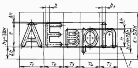
$l$  — линия шрифта;  $H$  — высота шрифта;  $b, b_1$  — толщина обводки;  $h$  — высота букв строчных;  $K$  — высота площадки по ГОСТ 26.020;  $h_2$  — расстояние от основания площадки до линии шрифта;  $\Delta h = 0,2$  мм для шрифта высотой  $H = 16$  мм;  $T_i$  — ширина площадки
