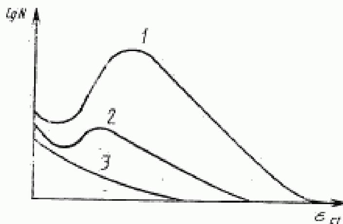
1—высокопрочные эластомеры, кристаллизующиеся при растяжении; 2—высокопрочные наполненные некристаллизующиеся резины; 3—малопрочные неаполненные резины
