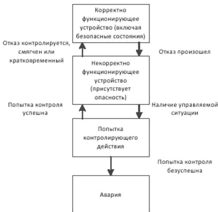
Рисунок 2 – Модель конечного автомата для оценки риска автомобиля
