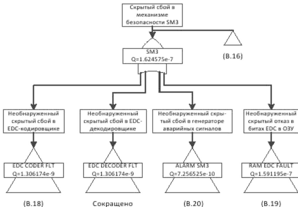
Рисунок В.17 – Ветвь дерева неисправностей, представляющая механизм безопасности SM3. Верхний уровень
