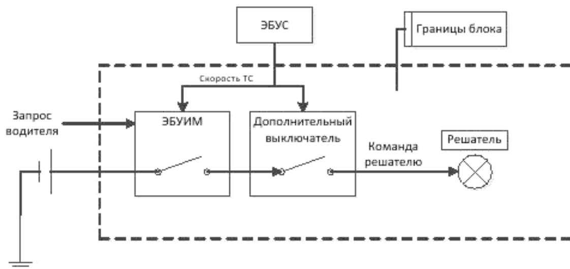
Рисунок 23 – Вторая итерация проекта устройства
