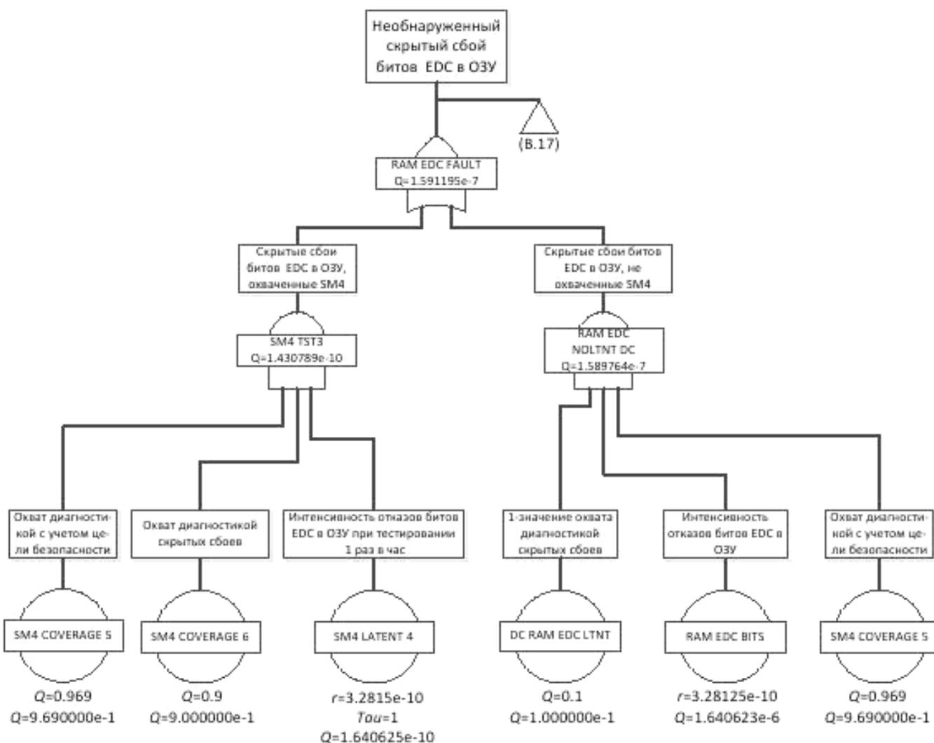
Рисунок В.19 – Ветвь дерева неисправностей, представляющая скрытые сбои битов EDC в ОЗУ
