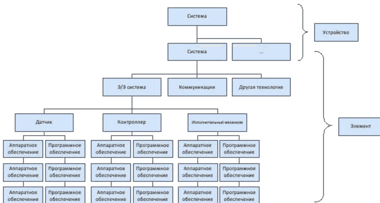
Рисунок 4 – Пример выделения компонент в устройстве
