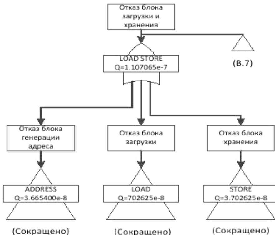
Рисунок В.13 – Ветвь дерева неисправностей верхнего уровня, представляющая блок загрузки и хранения
