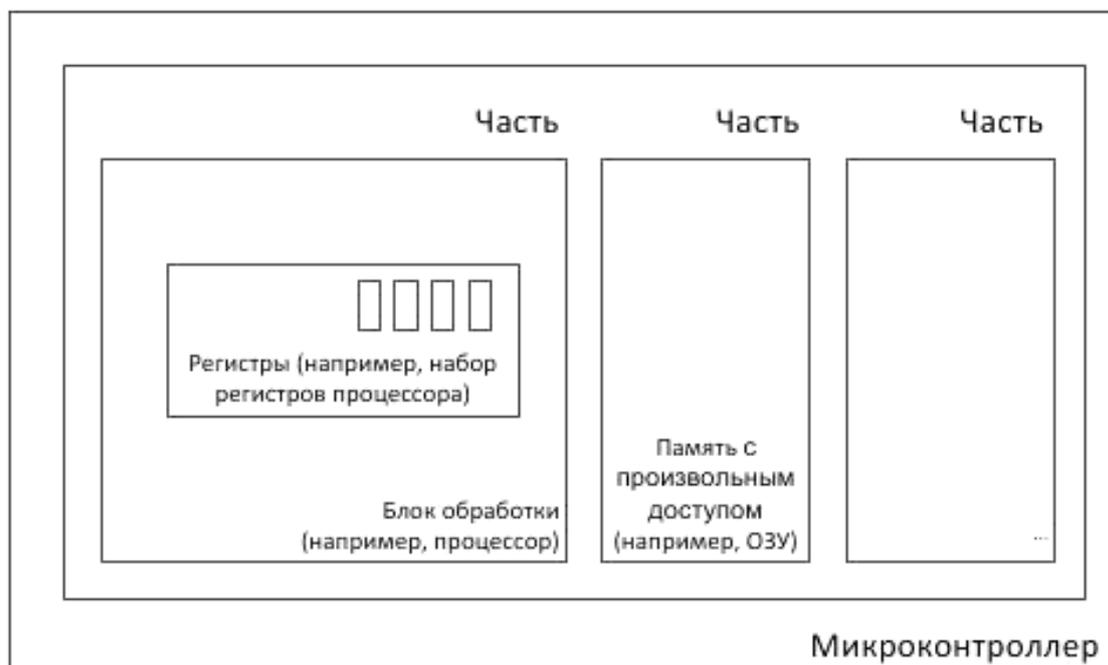
Рисунок А.1 – Микроконтроллер, его части и подчасти
