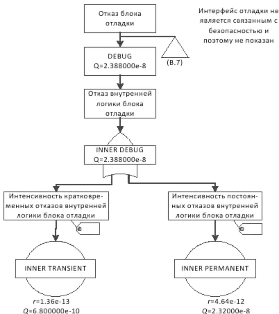
Рисунок В.14 – Ветвь дерева неисправностей, представляющая отладчик
