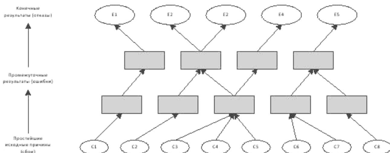
Рисунок В.1 – Иллюстрация метода FMEA («снизу вверх»)
