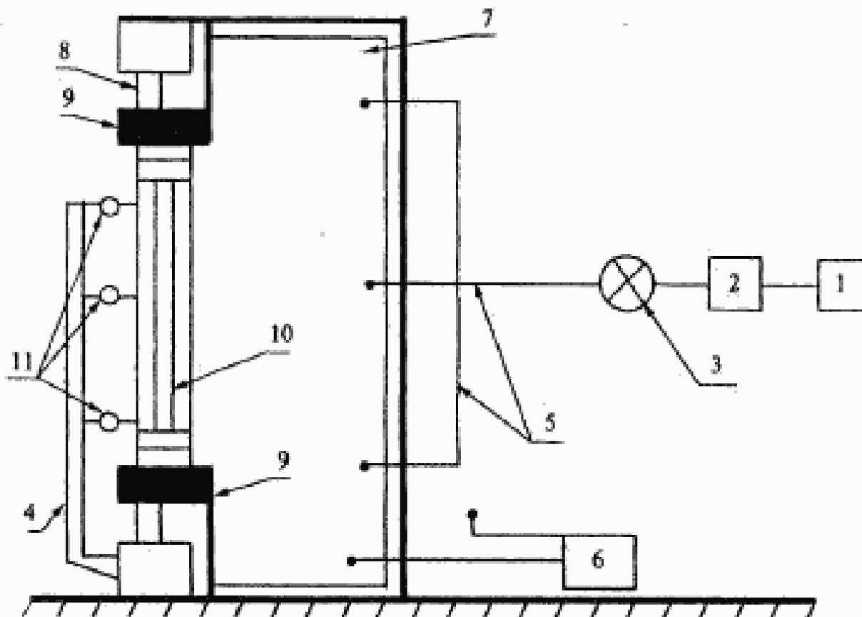
1 — компрессор (воздушный насос); 2 — регулятор расхода воздуха; 3 — запорный кран; 4 — приспособление для крепления измерительных приборов; 5 — шланги; 6 — датчики давления (манометры); 7 — герметичная камера; 8 — приспособление для крепления образца; 9 — эластичные уплотняющие прокладки; 10 — образец; 11 — измерительные приборы (например, цифровые индикаторы)
