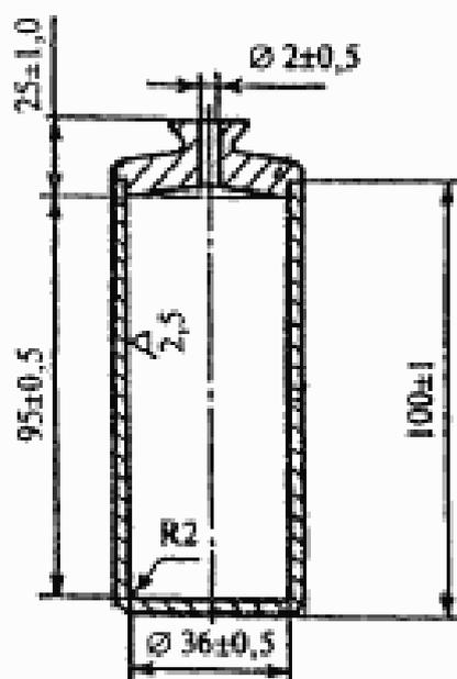
Рисунок 3 — Пикнометр
