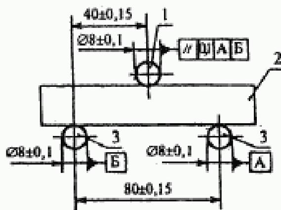
1 — нагрузочный элемент; 2 — образец-балочка; 3 — опора
