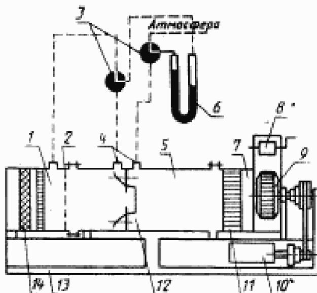
1 — приемная камера; 2 — рассеиватель; 3 — двухходовые краны; 4 — штуцера для присоединения микроманометра; 5 — измерительная камера; 6 — микроманометр; 7 — разгрузочная камера; 8 — заслонка; 9 — вентилятор; 10 — двигатель вентилятора; 11 — выпрямляющая решетка; 12 — измерительное сопло; 13 — основание сопла; 14 — смеситель воздуха
