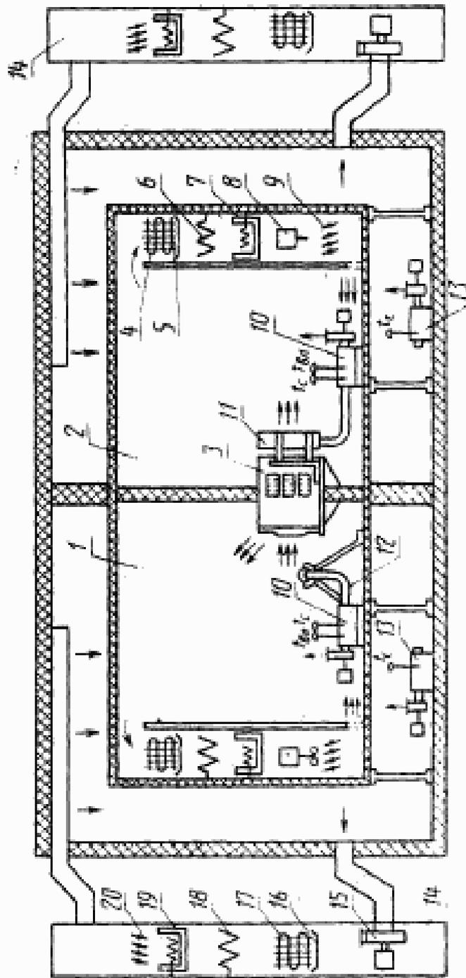
1 – внутренний отсек; 2 – наружный отсек; 3 – кондиционер (испытываемый); 4 – рассольный воздухоохладитель; 5 – поддон; 6 – нагреватель воздуха; 7 – увлажнитель; 8 – электроинтенсиватор; 9 – решетка; 10 – воздухозаборные устройства; 11, 12 – воздухозаборные трубы; 13 – воздухозаборные устройства; 14 – кондиционирующие устройства; 15 – электроинтенсиватор; 16 – поддон; 17 – рассольный воздухоохладитель; 18 – нагреватель воздуха; 19 – увлажнитель; 20 – решетка
