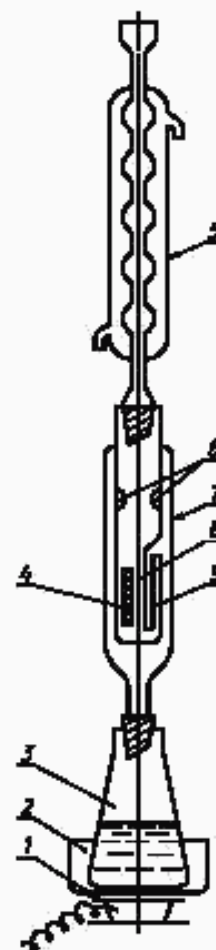
1 — электролитка; 2 — песочная банка; 3 — колба с n -гептаном; 4 — патрон с полимером; 5 — шариковый холодильник; 6 — отверстия; 7 — экстрактор; 8 — ловушка экстрактора; 9 — сифон
