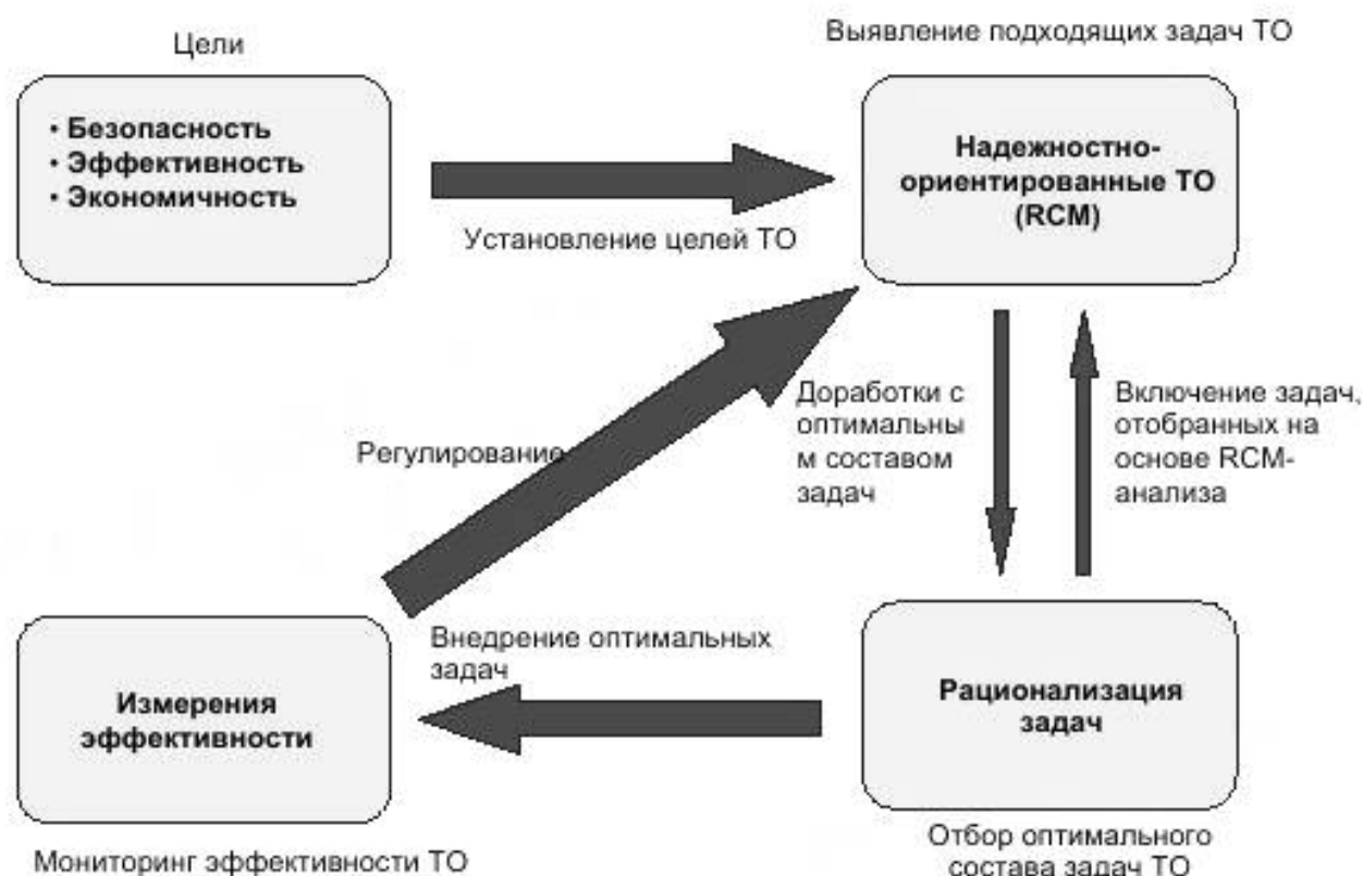
Рисунок 9 – Цикл непрерывного совершенствования надежности-ориентированной системы ТО
