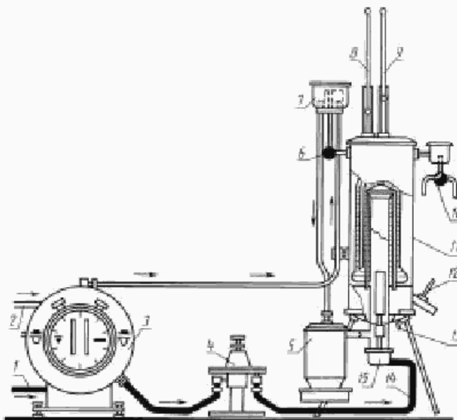
1 — газопровод; 2 — водопровод; 3 — газовый счетчик; 4 — мембранный регулятор давления высокой чувствительности; 5 — увлажнитель воздуха; 6 — вентиль для регулирования воды; 7 — передний бак для воды; 8, 9 — термометр для измерения температуры воды на выходе; 10 — трехходовый кран для нагретой воды; 11 — теплообменник; 12 — термометр для измерения температуры отходящих газов; 13 — выпускной патрубок конденсата; 14 — шланг газовой горелки; 15 — газовая горелка
