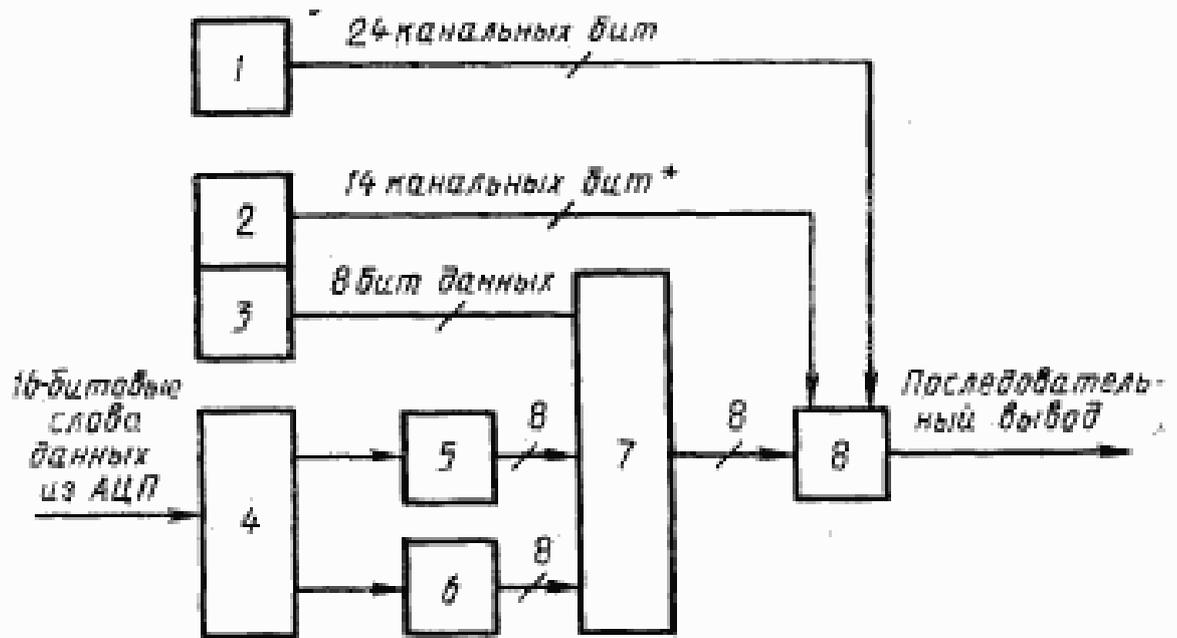
1—синхрогруппа; 2—синхрогруппа управления и отображения информации (УОИ); 3—кодер управления и отображения информации; 4—кодер CIRC; 5—24 символа данных; 6—8 проверочных символов; 7—мультиплексор; 8—модулятор
