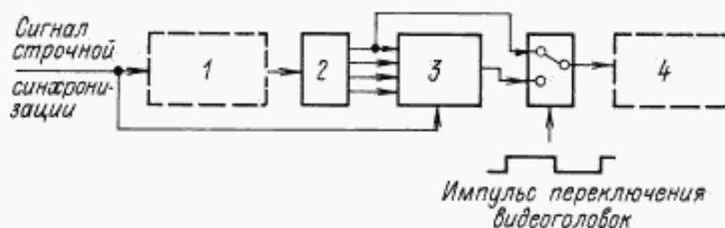
1 — умножитель частоты; 2 — делитель частоты на четыре;
