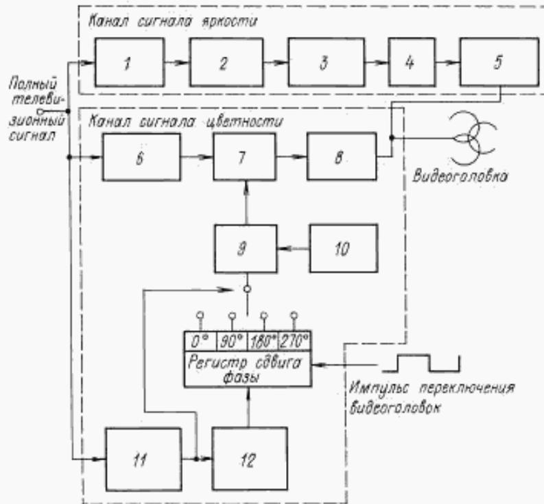
1, 8 — фильтры нижних частот; 2 — схема частотных предискажений; 3 — частотный модулятор;
