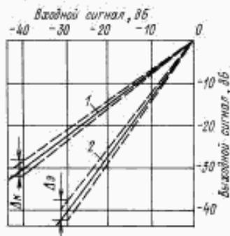
1 — АЧХ компрессора; 2 — АЧХ экспандера;  $\Delta_k = \pm 1,5$  дБ на частоте 315 Гц и уровне входного сигнала минус 40 дБ;  $\Delta_s = \pm 2,0$  дБ на частоте 315 Гц и уровне входного сигнала минус 30 дБ
