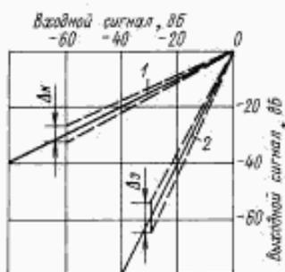
1 — АЧХ компрессора; 2 — АЧХ экпандера;  $\Delta x = \pm 1,5$  дБ на частоте 400 Гц и уровне входного сигнала минус 60 дБ;  $\Delta y = \pm 3,0$  дБ на частоте 400 Гц и уровне входного сигнала минус 30 дБ
