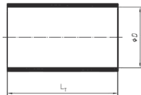
D – диаметр цилиндрической оправки; L_T – длина цилиндрической оправки
