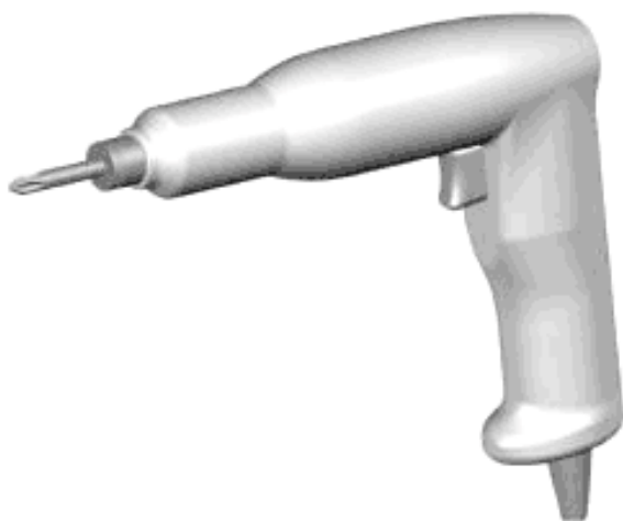
Рисунок 9 — Шуруповерт с рукояткой пистолетного типа
