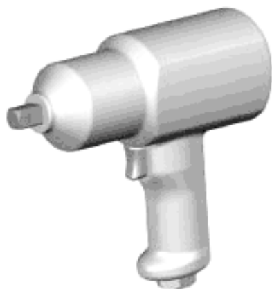
Рисунок 1 — Ударный/импульсный гайковерт с рукояткой пистолетного типа
