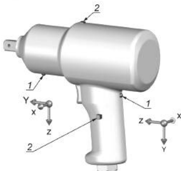
1 — предпочтительная точка измерений; 2 — дополнительная точка измерений
