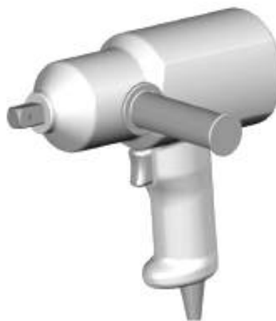
Рисунок 2 — Ударный/импульсный гайковерт с рукояткой пистолетного типа и прямой поддерживающей рукояткой
