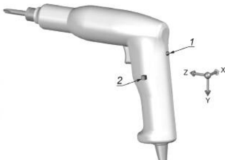
Рисунок 19 — Точки и направления измерений для шуруповерта с рукояткой пистолетного типа
