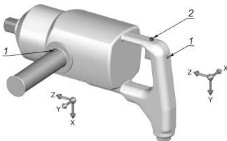
Рисунок 14 — Точки и направления измерений для ударного/импульсного гайковерта с дугообразной основной рукояткой и прямой поддерживающей рукояткой
