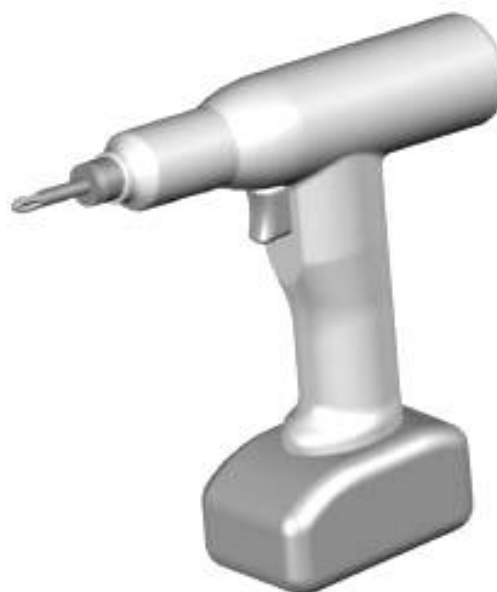
Рисунок 10 — Шуруповерт с центрированной рукояткой пистолетного типа
