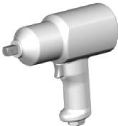
Рисунок 1 — Ударный/импульсный гайковерт с рукояткой пистолетного типа
