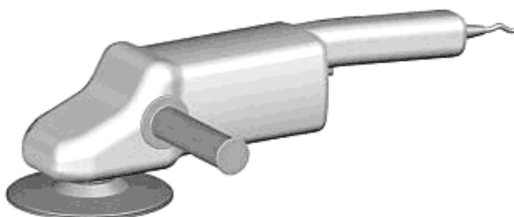
Рисунок 1 — Угловая круглошлифовальная/полировальная машина с обособленной основной рукояткой
