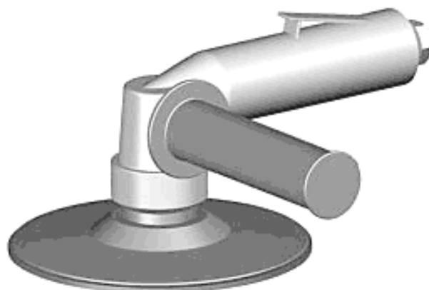
Рисунок 2 — Угловая круглошлифовальная/полировальная машина, в которой в качестве основной рукоятки используется корпус двигателя
