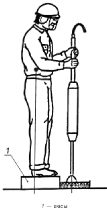
Рисунок 5 — Поза оператора при работе с напольной трамбовкой Рисунок 6 — Поза оператора при работе с верстачной трамбовкой
