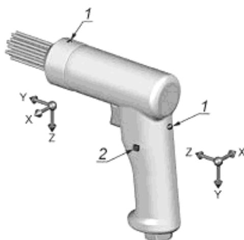
Рисунок 8 — Точки и направления измерений для прямого зубильного молотка
