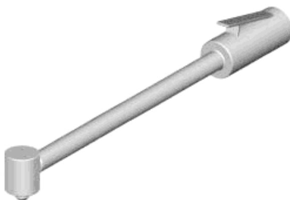
Рисунок 5 — Угловой зачистной молоток (камнетес)
