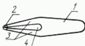
1 — тело пера; 2 — упрочнитель; 3 — половинка пишущего кончика; 4 — расщеп пера
