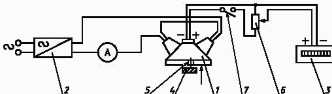
1 — рефлектометр (см. черт. 3); 2 — регулятор напряжения с точностью измерения до 0,1 % с трансформатором, регулирующим выходное напряжение ламп рефлектометра; 3 — гальванометр с градуировкой от 0 % до 100 % с фотоэлементом; 4 — эталон для градуировки: относительно белая поверхность. 99 %-ный сернокислый барий без защитного слоя; 5 — щель; 6 — потенциометр для градуировки гальванометра; 7 — выключатель
