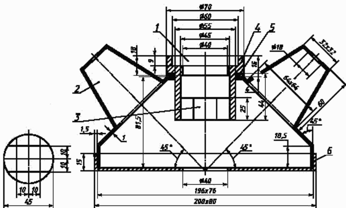
1 — расположение фотоэлемента с корректированием центрального отверстия; 2 — расположение лампы с цветовой температурой в пределах от 2800 до 2900 К, окрашенной внутри в белый матовый цвет; 3 — сканированная диафрагма, окрашенная в черный матовый цвет; 4 — съемное металлическое кольцо, окрашенное внутри в черный матовый цвет, а снаружи в белый матовый цвет; 5 — промежуточное асбестовое кольцо; 6 — съемная пластина с отверстием, окрашенная в черный матовый цвет
