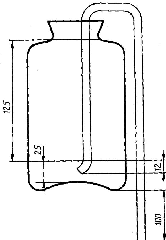
Операцию отмучивания повторяют два раза. При образовании хлопьев в верхнем слое смеси их удаляют. Для этого конец U-образной трубки помещают в верхней части слоя хлопьев и осторожно удаляют их в слив.
