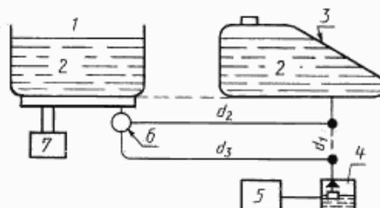
$d_1$  — первичная топливная трубка;  $d_2, d_3$  — топливные трубки измерительного устройства; 1 — вспомогательный бак; 2 — топливо; 3 — топливный бак; 4 — поплавковая камера карбюратора; 5 — двигатель; 6 — трехходовой клапан; 7 — весы
