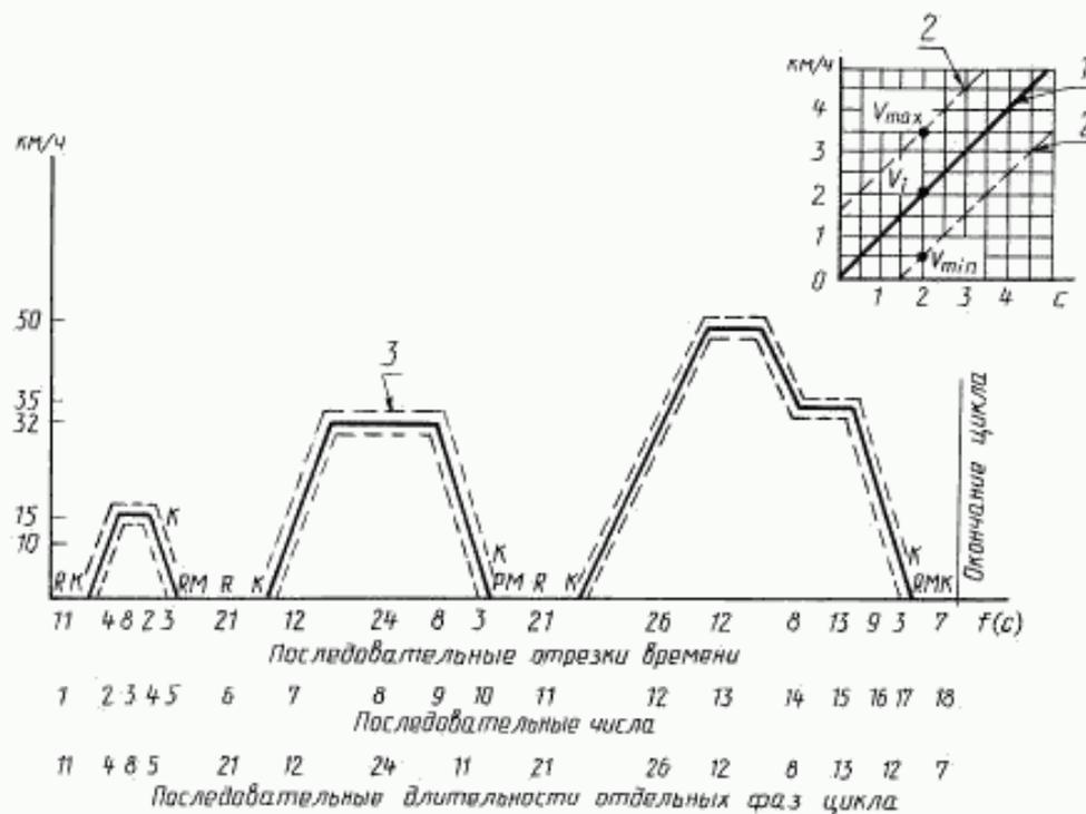
1 — теоретическая кривая цикла; 2 — границы допусков; 3 — допуски скорости ( $\pm 1$  км/ч) и времени ( $\pm 0,5$  с) складываются геометрически для каждой точки, как показано на позиции 2; К — сцепление выключено; РМ — КПП в нейтральном положении; R — холостой ход
