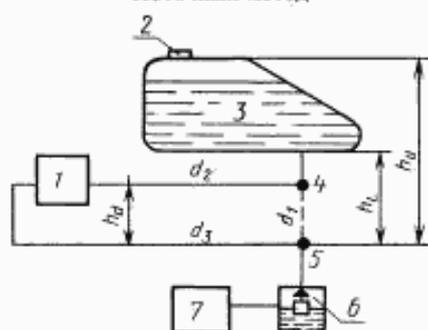
$h_u$  — верхний уровень топлива, мм;  $h_L$  — нижний уровень топлива, бензина, мм;  $h_d$  — падение давления в измерителе, мм;  $d_1$  — первичная топливная трубка;  $d_2, d_3$  — топливные трубки измерительного устройства; 1 — измерительное устройство; 2 — топливный бак; 3 — топливо; 4 — выпуск топливного бака; 5 — впуск топлива в карбюратор; 6 — поплавковая камера карбюратора; 7 — двигатель
