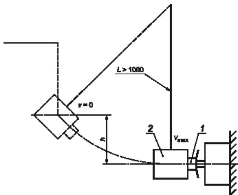
1 — деталь из резины с твердостью по Шору 45, диаметром 20 мм и длиной 18,5 мм; 2 — боек массой 1,6 кг. Рекомендуемый материал штанги — алюминиевая трубка длиной 1500 мм, диаметром 20 мм и толщиной 1 мм
