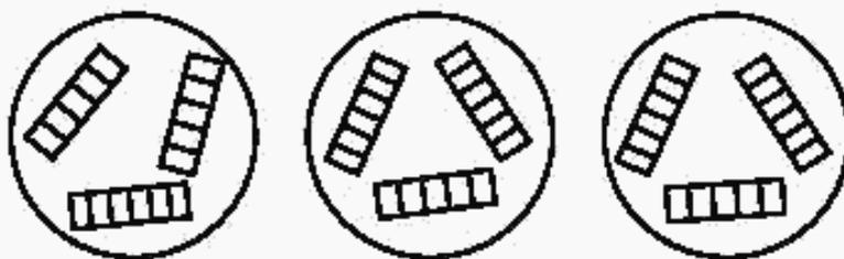
Рисунок 1 — Схема расположения подставок с образцами в эксикаторах
