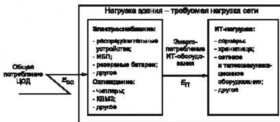
Рисунок А.1 — Схема расчета PUE на основе измерений
