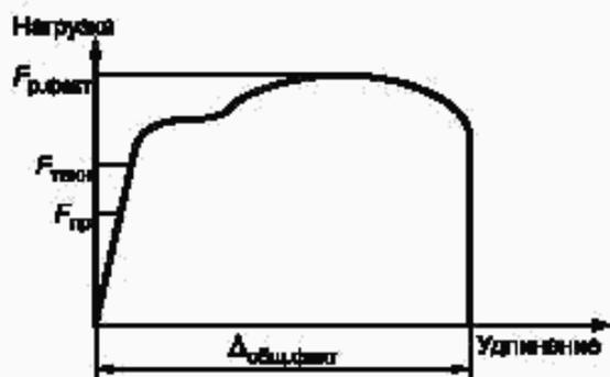
$F_{р.факт}$  — фактическая разрушающая нагрузка;  $F_{техн}$  — технологическая нагрузка;  $F_{пр}$  — приемочная пробная нагрузка;
