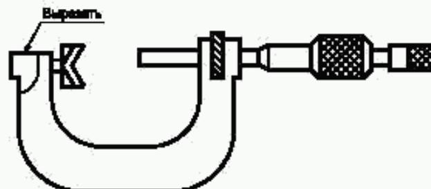
Рисунок В.2 — Микрометр для измерений
