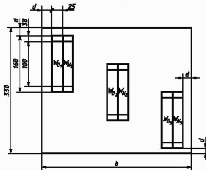
$W_{0_1} - W_{0_2}$  — контрольные элементарные пробы;  $W_{N_1} - W_{N_2}$  — рабочие элементарные пробы, предназначенные для многоциклового нагружения;  $d$  — расстояние от кромки или края точечной пробы до элементарной пробы;  $b$  — ширина ткани или трикотажного тканевязаного полотна
