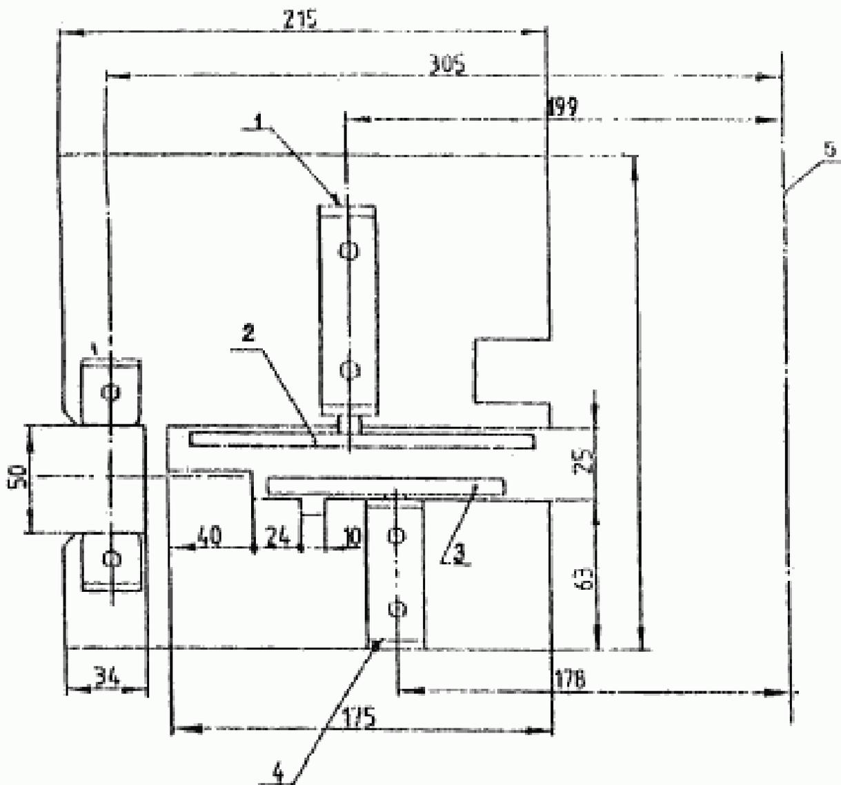
1 — вал приводного механизма; 2 — кулачок приводного механизма; 3 — кулачок с ограничителем хода; 4 — вал ручного управления; 5 — линия, проходящая через центр радиационной панели
