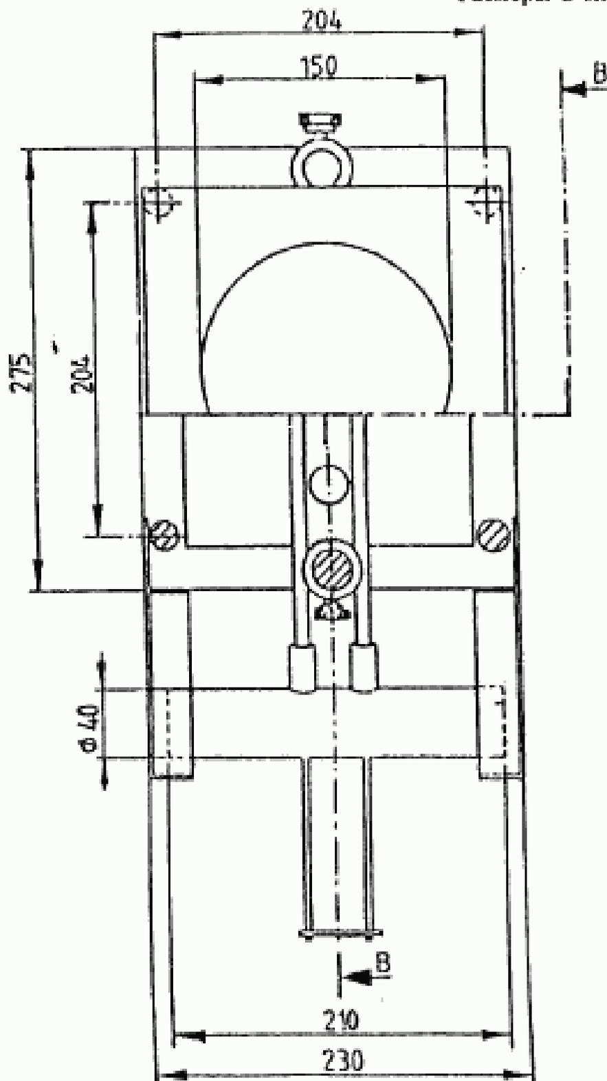
Рисунок А3 — Опорная станция (разрез по АА)
