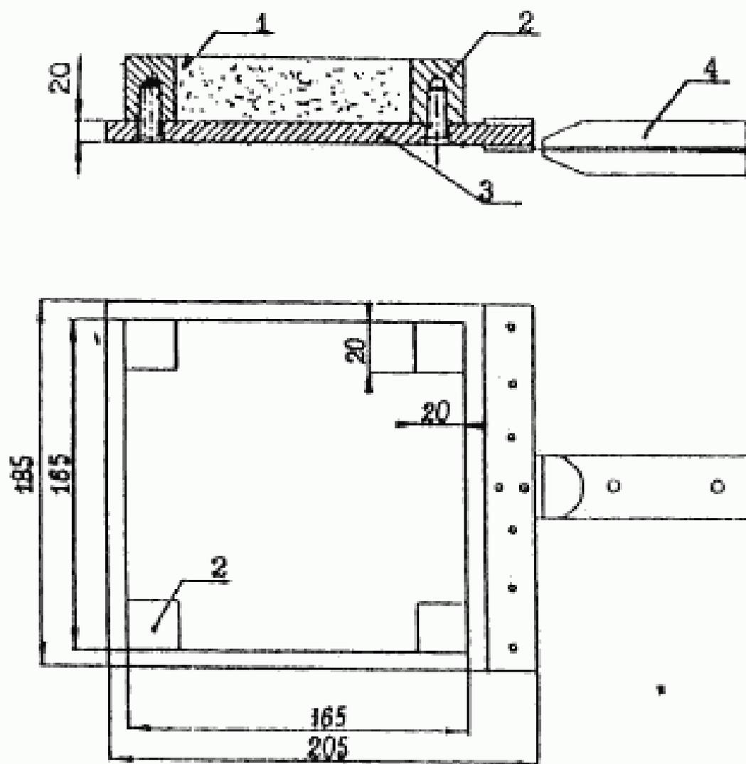
1 — плиты из минерального волокна; 2 — угловая стойка с самонарезным винтом;
