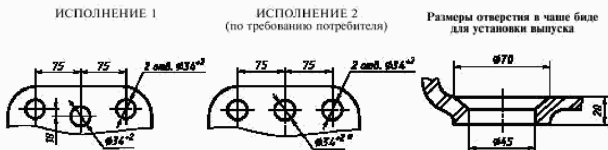
Рисунок 12 — Расположение и размеры отверстий в биде
