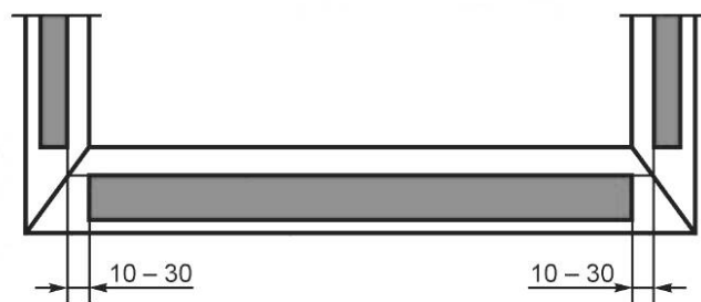
Рисунок 9 — Пример установки усиленных вкладышей в профилях ПВХ
