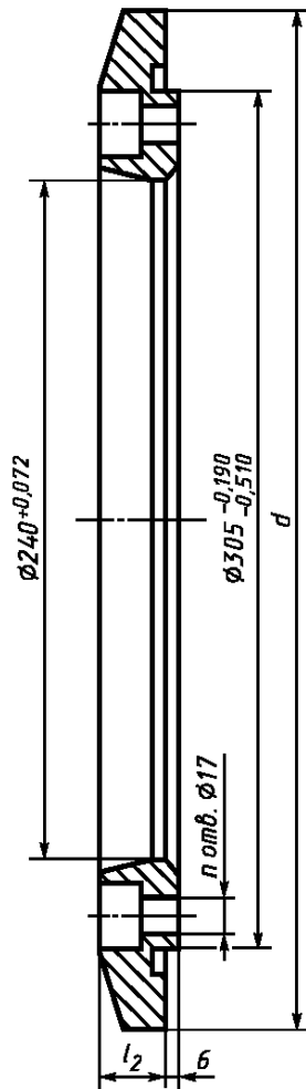
Рисунок 4 — Подвижный фланец с посадочным диаметром 305 мм
