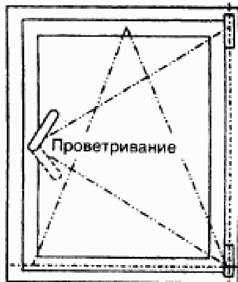
Рисунок А.4 — Устройство по- воротное (откидное, поворотнo- откидное) с функцией регули- руемого проветривания
