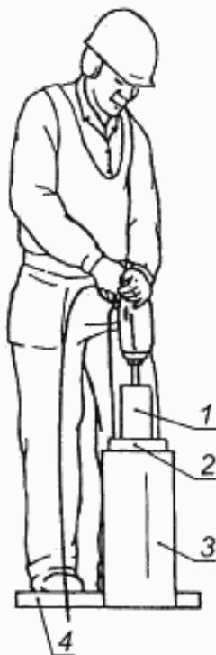
1 — поглотитель энергии; 2 — плита основания; 3 — бетонный блок (массой не менее 300 кг); 4 — весы
