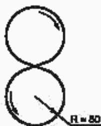
Рисунок 3 — Фигура, описываемая ручной машиной при движении по объекту обработки
