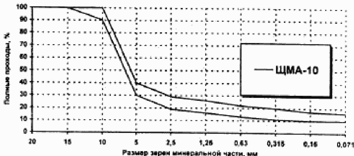
Рисунок Б.1 — Зерновой состав минеральной части ЦМА-10
