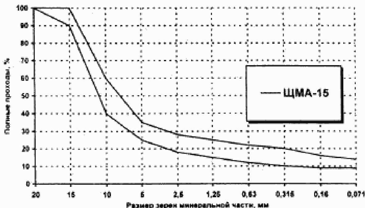
Рисунок Б.2 — Зерновой состав минеральной части ЦМА-15
