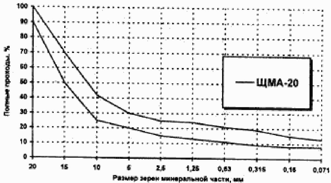
Рисунок Б.3 — Зерновой состав минеральной части ЦМА-20
