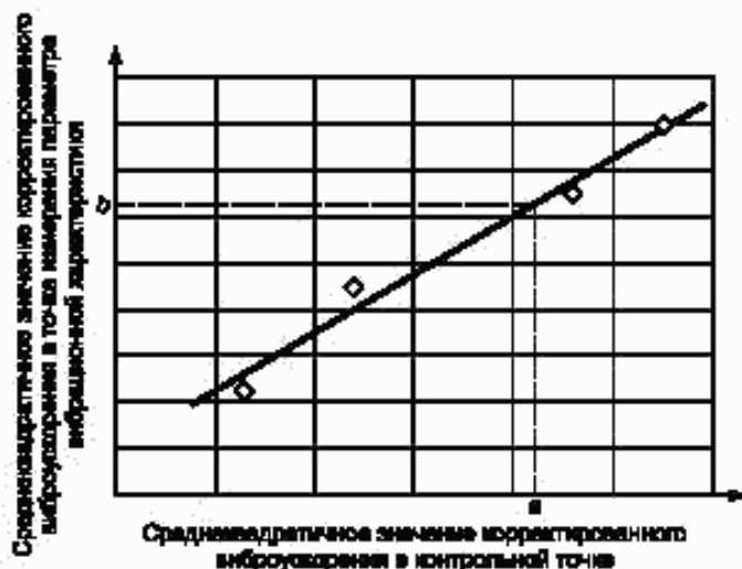
Рисунок F.2 — Пример результатов измерений, полученных для четырех разных скоростей передвижения машины, и построенной линии регрессии
