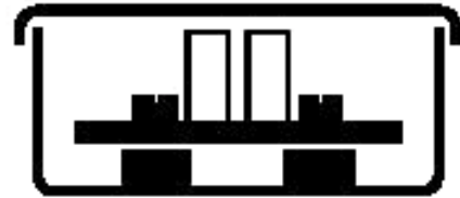
Рисунок В.2 — Коробка, составляющая единое целое с зажимом или с соединительным устройством
