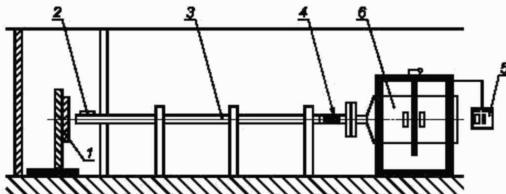
1 — объект испытаний; 2 — датчик скорости; 3 — ствол пушки; 4 — ударник; 5 — панель управления;
