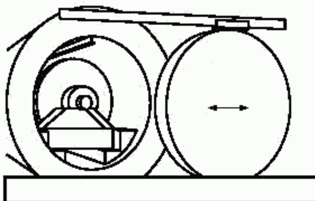
Рисунок С.6 — Туннель с за́слонкой для высо́коскоростного баланси́ровочного станка
