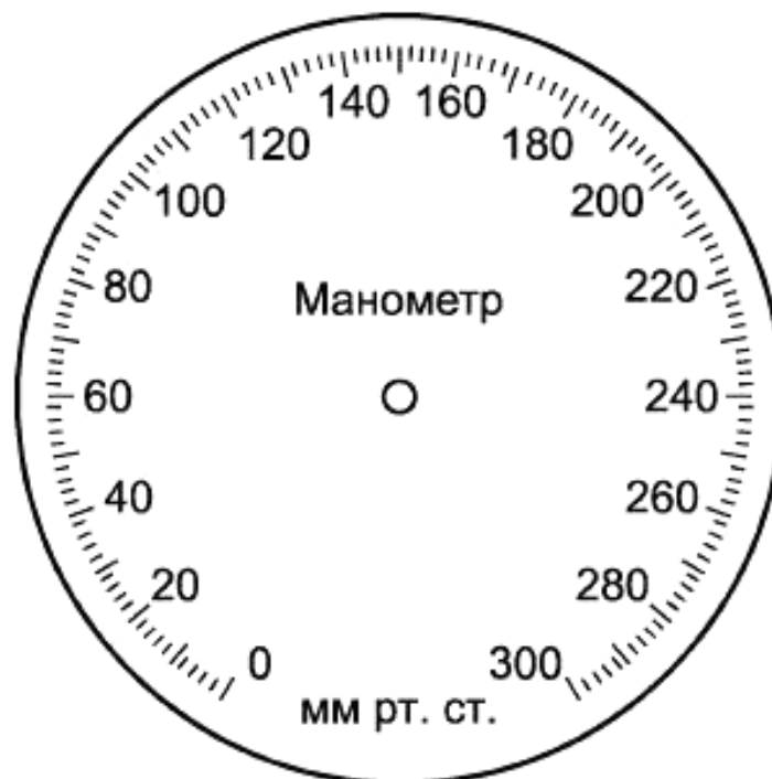
Рисунок 1 — Пример шкалы анероидного манометра (деление, мм рт. ст., без поля допуска в положении нуля, см. 7.1.4.2.3)
