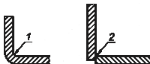
1 — радиус, получаемый при машинной обработке изогнутым лезвием, равный не менее 3,2 мм; 2 — радиус сварного шва, равный не менее 3,2 мм
