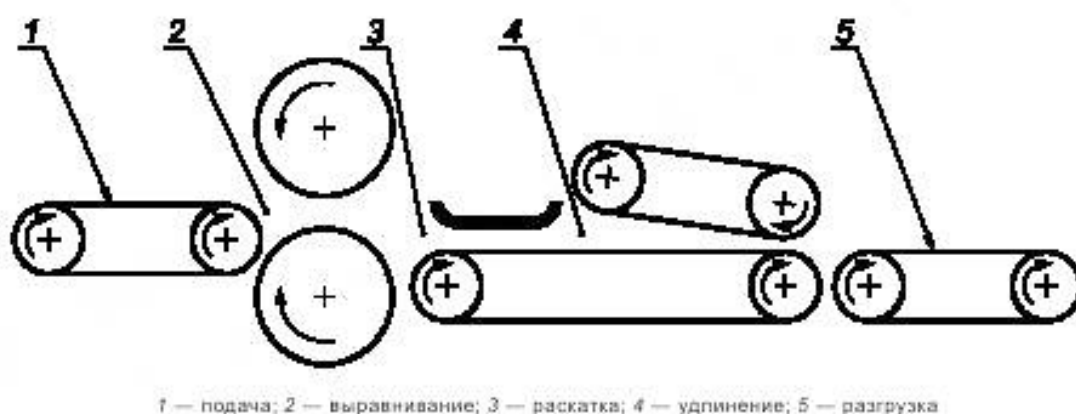
Рисунок 1 — Схема тестоформирующей машины
