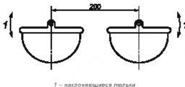
Рисунок 8 — Расстояние между осями крепления поднимающихся и опускающихся держателей люлек
