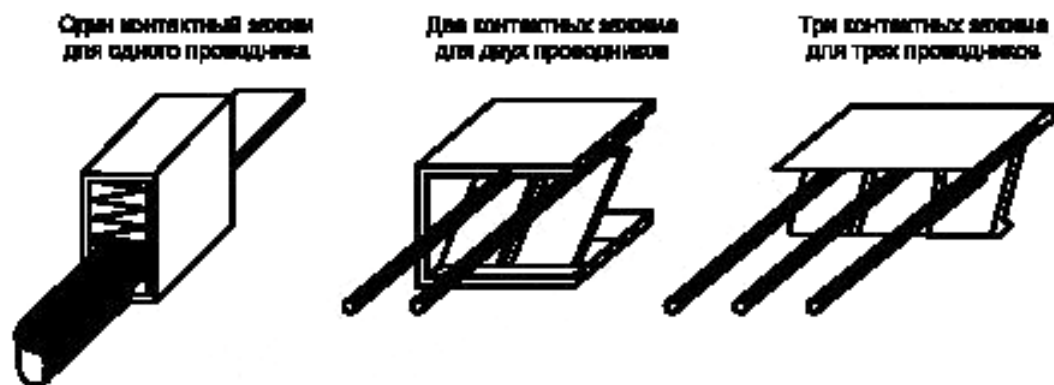
Рисунок F.6 — Примеры безвинтовых контактных зажимов
