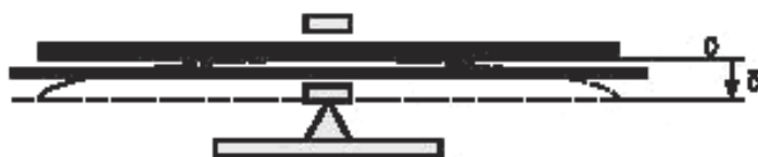
Рисунок 1 — Схема испытания модельных образцов гипсовых повязок прямоугольной формы по консольному бесконтактному методу
