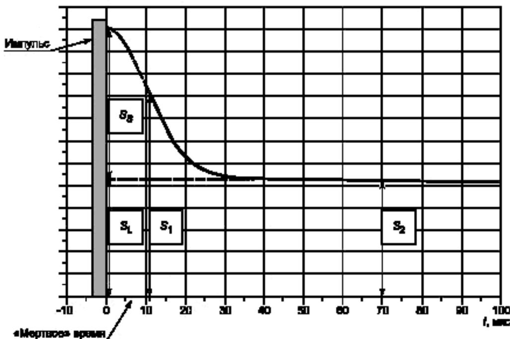
$S_L, S_S$  — амплитуда сигнала спада магнитной индукции жидкой и твердой фаз соответственно;  $S_T = S_L + S_S$  — амплитуда жидкой + твердой фазы;  $S_1, S_2$  — уровни сигнала магнитной индукции, измеренные при 11 и 70 мкс, соответственно
