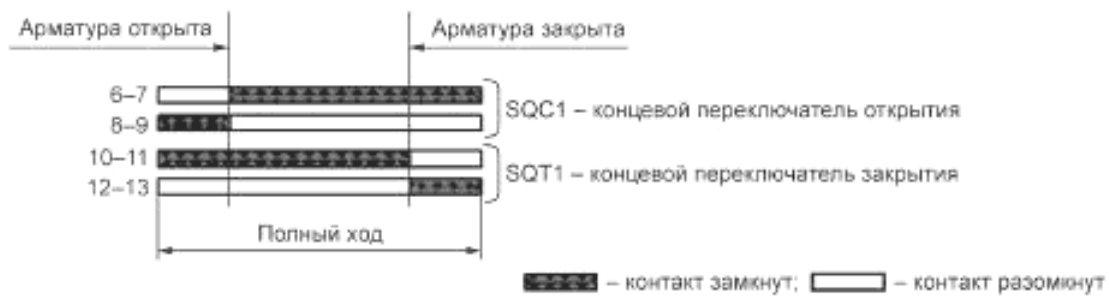
Рисунок У.3 — Электрическая схема соединения электромагнитов управления и концевых переключателей отсечной пневмоприводной быстродействующей арматуры (НО и НЗ) при установке под оболочкой и вне оболочки
