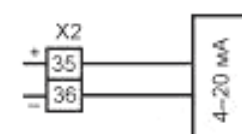
Схема подключения токового датчика
