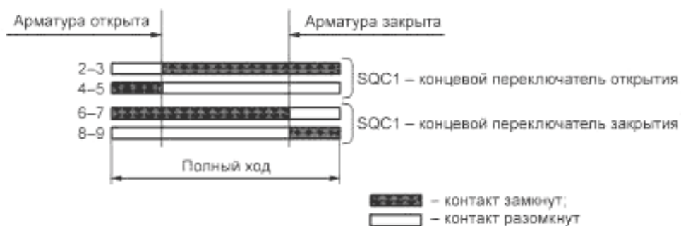
Рисунок У.1 — Электрическая схема соединения концевых переключателей арматуры с ручным управлением
