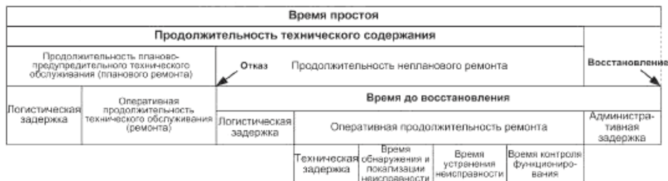
Рисунок А.1 – Составляющие продолжительности технического содержания
